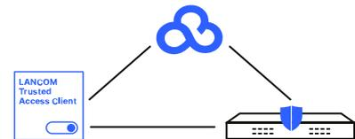
Ausschließlich der Datenaustausch zur Benutzerauthentifizierung findet über die LMC statt (Control Plane). Der anschließende Datenverkehr geschieht ohne Auskopplung über eine externe Cloud (Data Plane).
